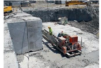
1 Para la extracción de los bloques de piedra, en la cantera se emplean máquinas de corte con sierra, entre otras.
